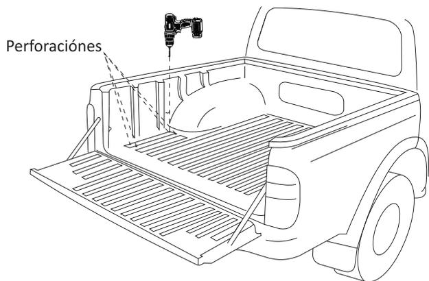
3 Una vez realizados los agujeros del paso 3 y ubicado el Baúl en la posición deseada se utilizará la bulonería y las placas de refuerzo provista en el kit de instalación para fijar el mismo a la caja del vehículo.
